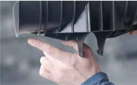
Los bordes curvados de todos los soportes tipo silla Insuguard permiten que la tubería aislada se mueva libremente por el soporte sin causar daños ni desgarros del aislamiento. Esto es especialmente importante para prevenir que se acumule condensación en líneas por debajo de la temperatura ambiente. En plafones expuestos como los de supermercados, la condensación o el congelamiento pueden causar tanto ingreso de humedad como goteras, que pueden ser un riesgo para las personas debajo.
