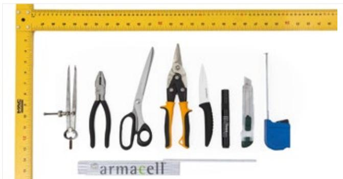
Figura 5: Herramientas recomendadas para la aplicación de ArmaGel HT.
