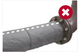
Figura 18: La unión longitudinal no debe estar en la parte superior.
